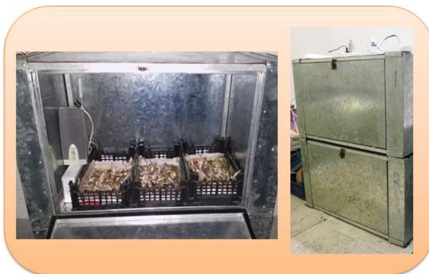
شکل ۱- جعبه صوت طراحی شده برای صوت دهی به بنه‌های زعفران Figure 1- Designed acoustic box for sonication to saffron corms.
